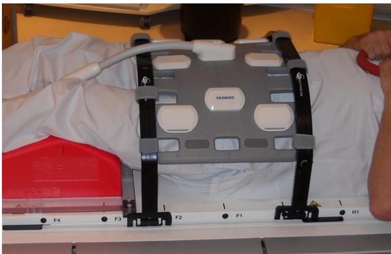
Figur 30. Spolupplägg med Body 18 long på ett Siemens Aera 1.5 T system i Göteborg. Spolbågarna förhindrar att spolen trycker på hudkonturen. Knäkudden sitter på en verkstadsgjord förflyttningsbar skena. Knäkudden bör vara av samma typ som på CT för att få bästa reproducerbara position av patienten.
