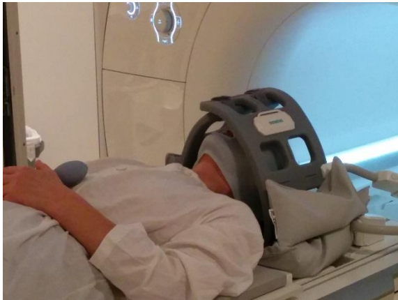
Figur 8. Spolupplägg för Siemens Aera 1.5 T system i Göteborg med 2 stycken Flex Large spolar virade runt huvudet. Spolarna sticks in och kläms fast under den platta bordstoppens huvuddel för att även täcka bakre delen av huvudet, och sätts ihop framtill med kardborreband. Med detta upplägg används inte ryggspolens element. Spolarna stöds med sandsäckar på sidorna för att komma närmre huvudet och undvika att de trycker på patientens näsa och ansikte.
