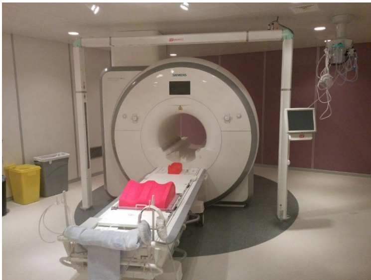
Figur 26. Magnetkamera utrustad med platt bordstopp och fixationssystem för strålterapi. Observera det externa lasersystemet som sitter på bågen runt om kameran.
