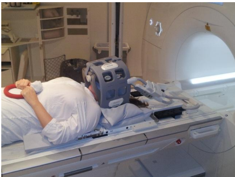
Figur 14. Spolupplägg för Siemens Aera 1.5 T system i Göteborg med 2 stycken Flex Large spolar som täcker främre delen av huvudet. Bakre delen av huvudet täcks av spine-elementen i bordet.
