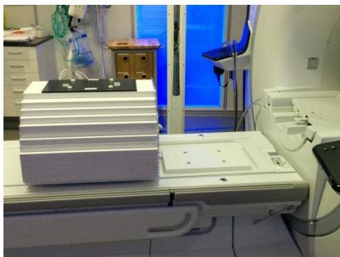
Figur 52. GE-fantomet från sidan. Plexiglasskivan är lagd i bordet.
