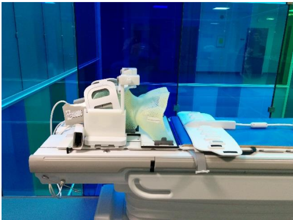
Figur 12. Spolupplägg för GE Discovery 750W 3.0 T system i Lund. Uppsättningen kallas GEM RTSuite och här används två delar: 1) GEM RT Open Array som är en tilläggs-skiva i bordet (ej synlig), 2) 6-Channel Flex Coil, sitter till vänster och höger om huvudet. Den avlånga spolen som ligger nedanför används inte.
