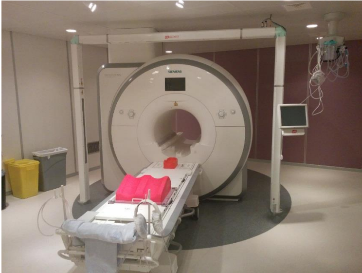
Figur 31. Magnetkamera utrustad med platt bordstopp och fixationssystem för strålterapi. Observera det externa lasersystemet som sitter på bågen runt om kameran.
