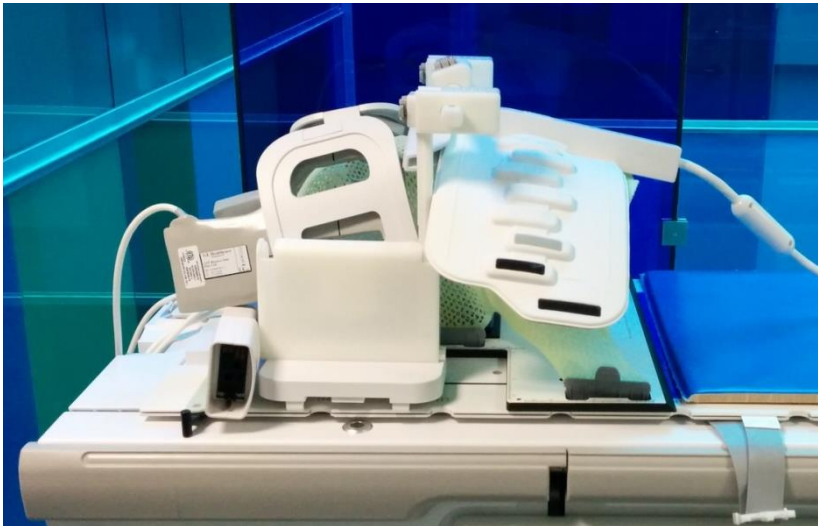
Figur 23. Spolupplägg för Head och Neck på ett GE Discovery 3.0 T 750W system i Lund. Uppsättningen kallas GEM RTSuite och består av 3 delar. Dessa delar är 1) GEM RT Open Array som är en tilläggs-skiva i bordet (ej synlig), 2) GEM Flex Coil 16-L Array, 3) 6-Channel Flex Coil. Distansbågar och hållare syns också i bild runt de synliga spolarna.
