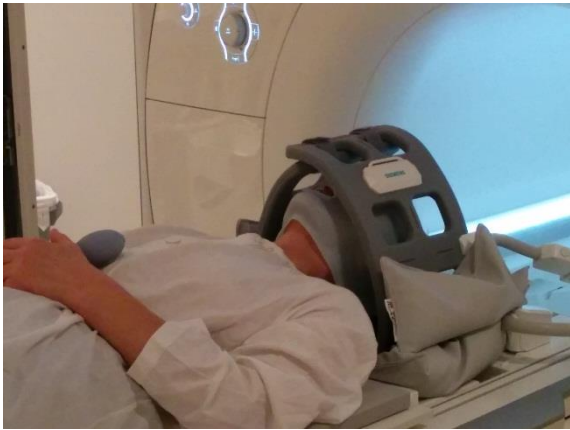
Figur 11. Spolupplägg för Siemens Aera 1.5T system i Göteborg med 2 stycken Flex Large spolar virade runt huvudet. Spolarna sticks in och kläms fast under den platta bordstoppens huvuddel för att även täcka bakre delen av huvudet, och sätts ihop framtill med kardborreband. Med detta upplägg används inte ryggspolens element. Spolarna stöds med sandsäckar på sidorna för att komma närmre huvudet och undvika att de trycker på patientens näsa och ansikte.
